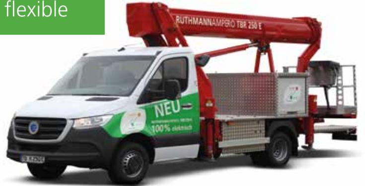
Im ersten vollelektrischen **E-STEIGER®** AMPERO TBR 250 E haben wir ein einzigartiges Konzept umgesetzt. Beim AMPERO wird zentral nur **eine Batterie für den Fahrtrieb** des ORTEN-Sprinters und gleichzeitig für den **STEIGER®-Antrieb** genutzt. Mit dem AMPERO fahren und arbeiten Sie **geräuscharm sowie abgasfrei**. Diesel-Fahrverbote sind mit dem E-STEIGER® kein Problem mehr.
